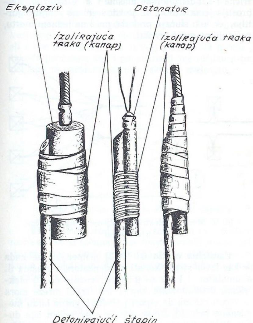
Sl. 25. Način paljenja detonirajućeg štapina
